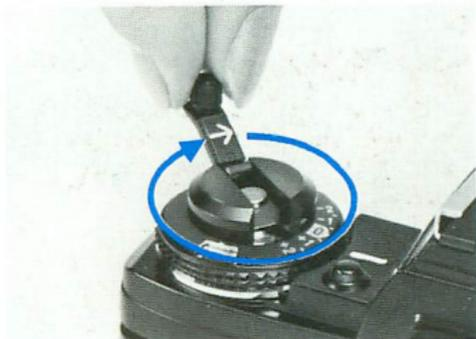
2. Rückspulkurbel ausklappen und in Pfeilrichtung drehen, bis der rote Balken des Filmladesignals nach links aus dem Fenster verschwunden ist. Dann dreht sich nach dem Überwinden eines etwas stärkeren Widerstands die Kurbel leicht und frei.
