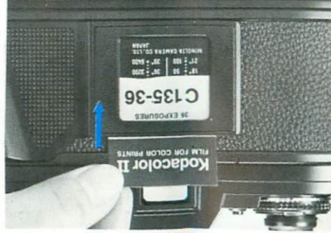
Die DIN/ASA-Vergleichstabelle auf der Rückwand ist von einem praktischen Rahmen, dem Memohalter, umgeben, der genau die richtige Größe zum Hineinstecken eines Filmpak-kungsdeckels oder anderer Notizen hat. So sieht man immer genau, welcher Film sich in der Kamera befindet.
