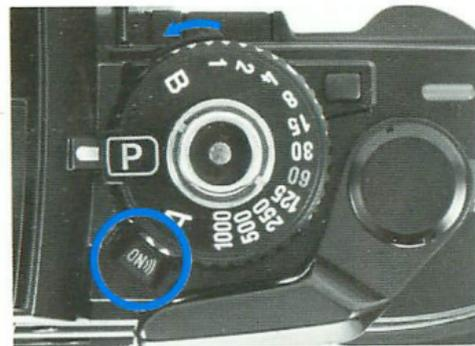
Wird die Kamera nicht benötigt, stellt man den Hauptschalter auf OFF. Dadurch werden unbeabsichtigte Aufnahmen verhindert, und es wird unnötige Stromentnahme vermieden. (Auch wenn der Hauptschalter in einer der ON-Positionen steht, wird nur beim Berühren des Auslösers Batteriestrom verbraucht. Man sollte deshalb die Kamera – um in „Schußbereitschaft“ zu bleiben – nur ausschalten, wenn man sie für längere Zeit weglagt.)
